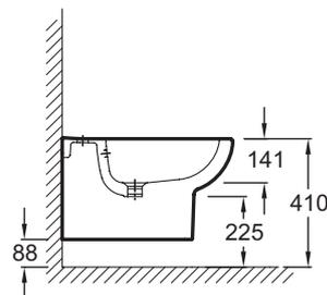
Descriptif CCTP : Bidet suspendu. E4765. Collection : ODÉON UP. DIMENSIONS : 54 x 36,50 cm. POIDS : 19 kg. MATÉRIAU : Céramique. TYPE D'INSTALLATION : Suspendu. NORMES ET RÉGLEMENTATIONS : NF. PRODUIT INCLUS : (robinetterie non incluse). MÉCANISME SILENCIEUX : Silencieux classe 1. ISOLATION PHONIQUE ET THERMIQUE DU RESERVOIR : No. GARANTIE DE LA CÉRAMIQUE : 10 ans. CONDITIONNEMENT : Un seul colis. Percé 1 trou de robinetterie. Semi-caréné.
