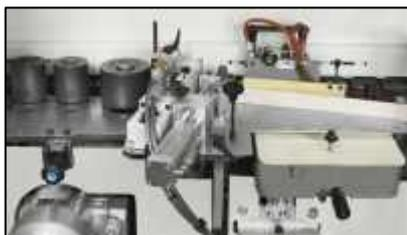
Le groupe effectue l'encollage automatique des chants en rouleau et bandes sur panneaux droits avec colle thermo fusible.
