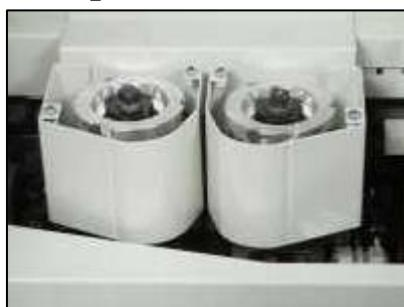
Il effectue la rectification du panneau, en réalisant une surface optimale pour l'application de la colle et pour obtenir une parfaite ligne de jonction avec le chant.
