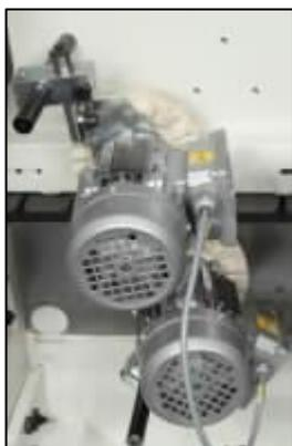
Avec deux moteurs indépendants (P=0,13 kW et tournant à la vitesse de 1400 tr/min) pour le nettoyage et le lustrage du chant.
