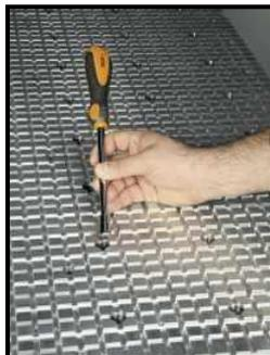
"HE" table en aluminium laminé à haute efficacité, à une zone d'usinage.
