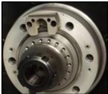
Il permet le montage des têtes à renvoi angulaire sur l'électro mandrin, avec système à accouplement mécanique fixe.
