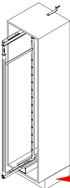
1. Le caisson doit être fixé au mur tel que montré.
