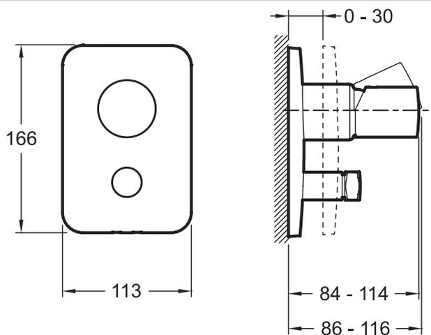
Descriptif CCTP : Mitigeur mécanique avec deux sorties, façade et levier Toobi. E98719. Collection : TOOBI. POIDS : 2,5 kg. TYPE D'INSTALLATION : Encastré. NORMES ET RÉGLEMENTATIONS : ACS : 10 ACC LY 004.
