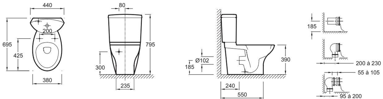
Descriptif CCTP : Cuvette vario. 19077. Collection : PRESQU'ÎLE. DIMENSIONS : 69,50 x 38 cm. POIDS : 28,4 kg. MATÉRIAU : Céramique. TYPE D'INSTALLATION : Au sol. CONSOMMATION D'EAU : Standard 3/6 L. HAUTEUR : Standard. TYPE DE BRIDE : Ouverte (traditionnelle). TYPE D'ABATTANT : Déclipsable à descente progressive. PRODUIT INCLUS : (réservoir non inclus). LIVRÉ AVEC : Abattant thermodor à descente progressive et déclinable E70016, charnières métal.
