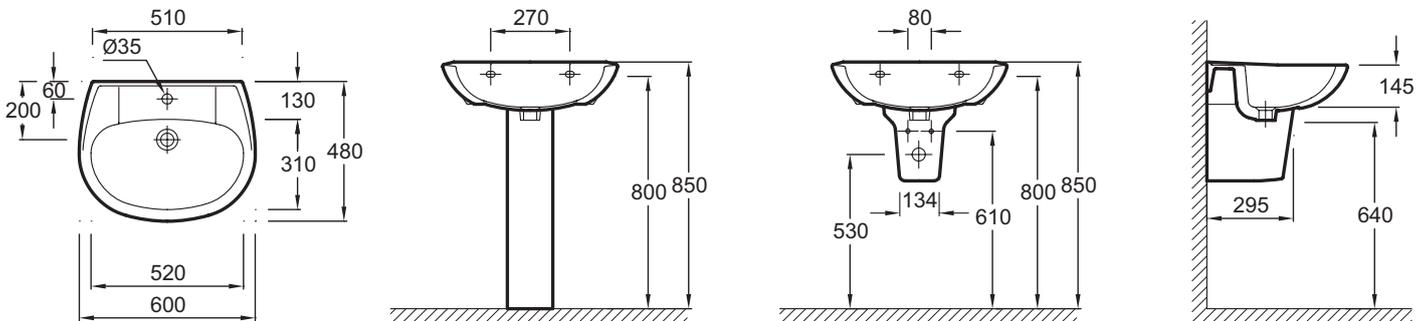
Descriptif CCTP : Lavabo 60 cm, sans trou de trop-plein. E1288. Collection : BRIVE. DIMENSIONS : 60 x 48 cm. POIDS : 13,9 kg. MATÉRIAU : Céramique. TYPE D'INSTALLATION : Autoportant. FIXATIONS : 3 types de fixations possibles : Goujons, consoles ou crochets. PERCEMENT ROBINETTERIE : Percé 1 trou pour robinetterie. CONFIGURATION : STANDARD. TROP-PLEIN : Sans trou de trop plein. PRODUIT INCLUS : (robinetterie non incluse).
