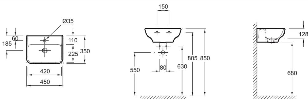
Descriptif CCTP : Lave-mains 45 cm non meulé. EGH111. Collection : STRUKTURA. DIMENSIONS : 45 x 35 cm. POIDS : 10 kg. MATÉRIAU : Céramique. PERCEMENT ROBINETTERIE : Percé 1 trou pour robinetterie. MEULÉ/NON-MEULÉ : A installer avec un meuble. TROP-PLEIN : Avec trou de trop plein. PRODUIT INCLUS : (robinetterie non incluse).
