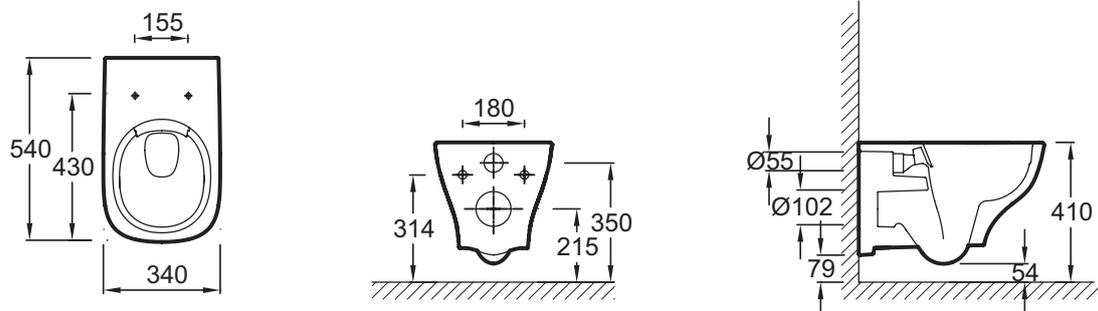
Descriptif CCTP : Cuvette suspendue SANS BRIDE. EDE101. Collection : STRUKTURA. DIMENSIONS : 54 x 34 cm. MATÉRIAU : Céramique. TYPE D'INSTALLATION : Suspendu. CONSOMMATION D'EAU : 2,6/4 L et 3/6 L. HAUTEUR : Confort. TYPE DE BRIDE : Sans bride. BRIDE : Sans bride. PRODUIT INCLUS : (abattant, bâti-support et plaque de commande non inclus). ABATTANT : Non inclus. GARANTIE DE LA CÉRAMIQUE : 10 ans. CONDITIONNEMENT : Un seul colis.
