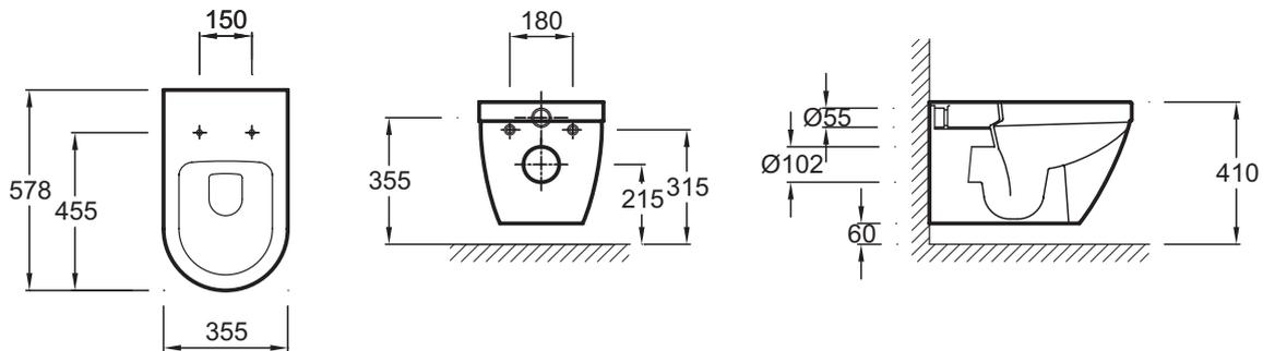
Description : Cuvette suspendue. EDC102. Collection : RODIN. Dimensions : 57,80 x 35,50 cm. Poids : 27,5 kg. Matériau : Céramique. Type d'installation : Suspendu. Consommation d'eau : Standard 3/6 L. Hauteur : Standard. Type de bride : Fermée.
